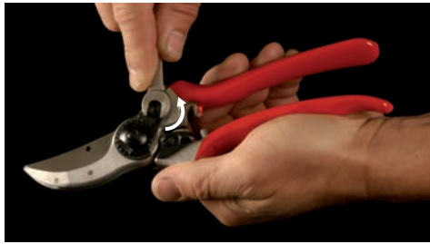
2. Lösen der Schraube des gezahnten Sektors
