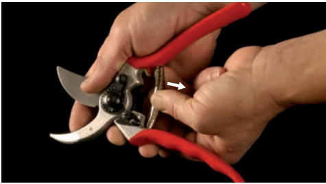
4. Demontieren der Klinge, falls notwendig ersetzen
