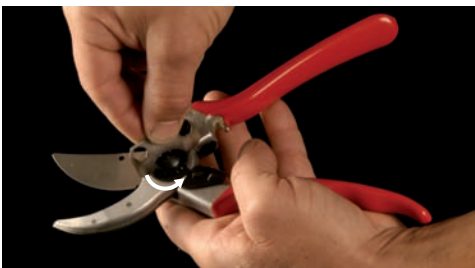
4. Demontieren der Klinge, falls notwendig ersetzen
