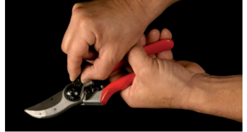
10. Lösen, einstellen, ausrichten des Drehmoments der gezahnten Mutter
